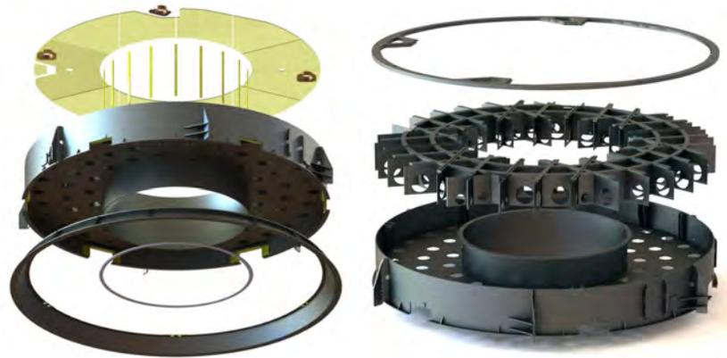
Izquierda: Una visión abierta del Ensamblaje de Celda del M2 muestra los paneles de control de temperatura removibles en la parte superior de los anillos de apertura y los frenos de seguridad en la parte inferior. Los frenos de seguridad evitan daños causados por movimientos sísmicos.
